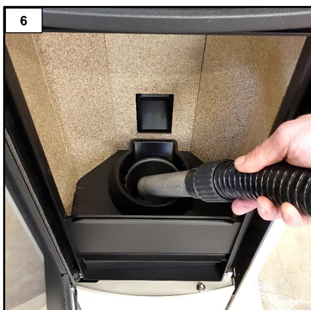
Aspirer, avec un aspirateur vide cendres, la cendre qui s'est déposée sous le brasier (figure 6) et hors du brasier (figure 7).
