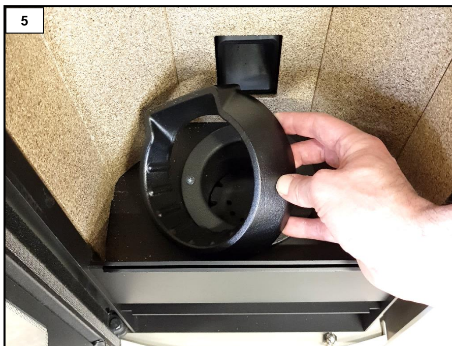
Enlever la bague de couverture du brasier et enlever les résidus de combustion (figure 5).
