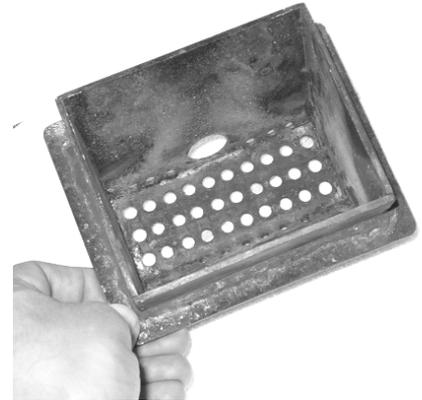
Exemple de pot à combustion propre
