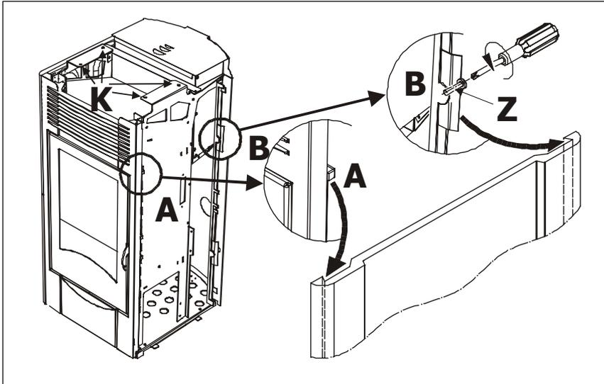
Prendre un carreau de l'emballage (avec les tiges pré-montées), se placer sur le côté du poêle et insérer le carreau par devant de telle sorte que les **fixations (A)** butent contre le bord biseauté antérieur du carreau.
