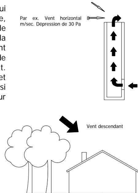
En dehors de la direction et la force du vent, la position du conduit de fumée et de la sortie de toit par rapport au toit de la maison et au paysage environnant, est également importante.
