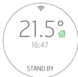
Lorsque la température ambiante atteint la température configurée et que tous les autres paramètres sont respectés (voir paragraphe suivant), l'appareil s'éteint et l'écran affiche la température ambiante, l'heure en cours et l'indication STANDBY pour indiquer un état de veille qui permet au produit de se rallumer dès que la température descend en dessous du seuil configuré ou si la température souhaitée dans la pièce augmente.
