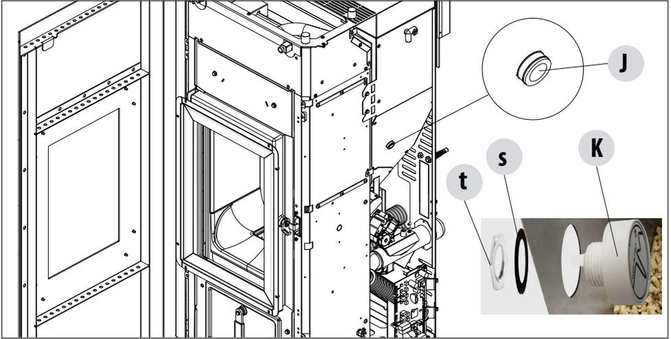
Le capteur des pellets est un indicateur de réserve du combustible afin d'avertir l'utilisateur que les pellets se terminent.
