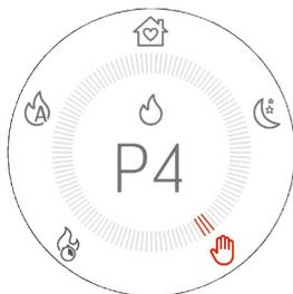
Les touches permettent de modifier la puissance de la flamme et en cas de pression sur les touches, au centre de l'écran, tous les messages disparaissent pour ne laisser apparaître que le réglage en cours.
