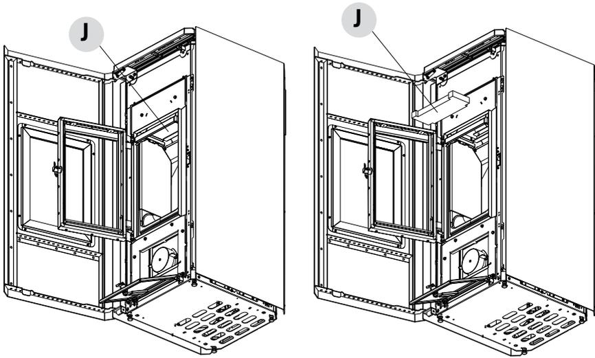
À l'aide d'une tige rigide ou d'une brosse pour bouteilles, gratter les parois du foyer (voir la flèche - respectivement à droite et à gauche/ sur et sous du foyer) de façon à laisser tomber les cendres dans le compartiment inférieur.
