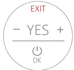
En revanche, si l'on décide de passer tout de même en mode TURBO avant que les 60 minutes ne soient écoulées, un compte à rebours s'affiche jusqu'à ce qu'il soit possible d'activer le mode. Si l'on décide de rester dans cette condition alors que les 60 minutes ne sont pas écoulées, le mode TURBO commencera à fonctionner dès que le compte à rebours sera arrivé à 00:00. En attendant, le produit fonctionnera dans le mode où il se trouve.
