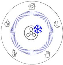
Lorsque le produit fonctionne pendant un nombre élevé d'heures (par exemple 6 heures) en continu à la puissance maximale (déconseillé sur la base des mises en garde visées au chapitre 1 de la « PARTIE 1 » du manuel), un cycle de refroidissement obligatoire d'une durée de 30 minutes intervient. Lorsque cela se produit, l'écran affiche ce qui est indiqué ci-contre.
